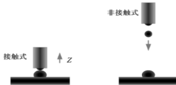
图1：点胶机技术可以分为接触式点胶技术和非接触式点胶技术
