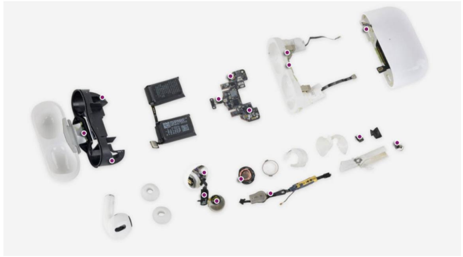
图7: TWS 耳机的点胶位置
