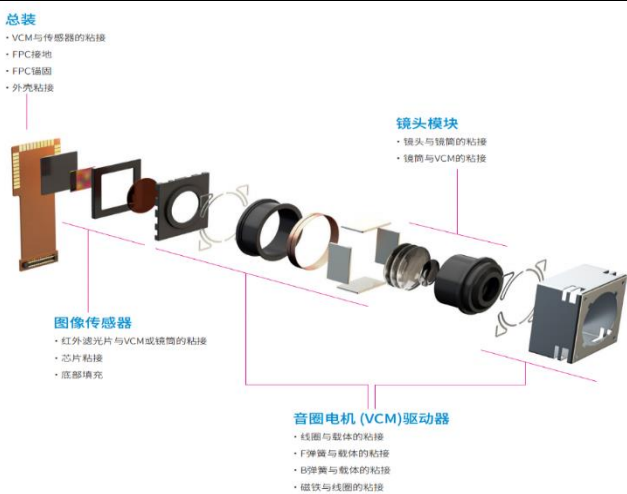
图5：手机镜头模组需要点胶工艺精密粘接
