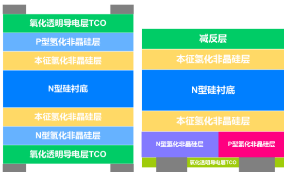
图42: HJT (左)、HBC (右) 电池结构对比
